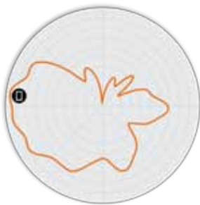
図2. R560 2.4GHz 方位角アンテナ・パターン
