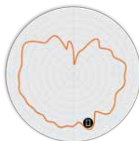
図3. R560 5GHz 方位角アンテナ・パターン
