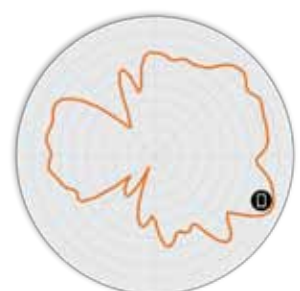
図4. R560 6GHz 方位角アンテナ・パターン
