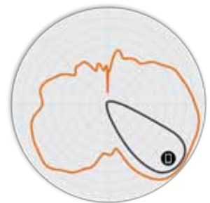
図7. R560 6GHz 仰角アンテナ・パターン
