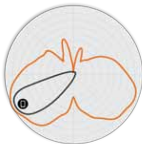
図6. R560 5GHz 仰角アンテナ・パターン
