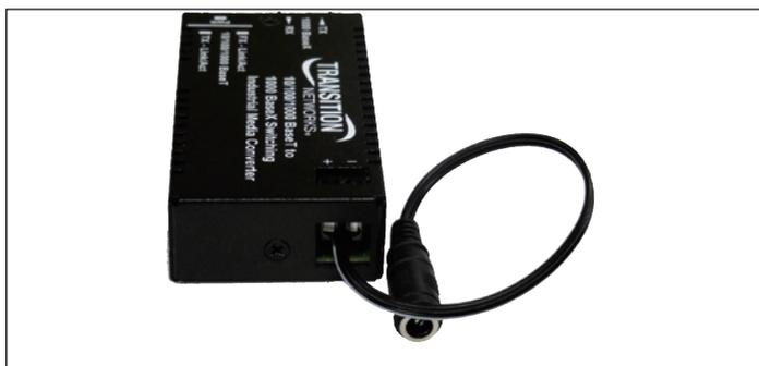
M/E-ISW-FX-02 に必要な電源は、DC12V ~ 48V または AC24V ~ 36V のどちらかの外部電源を用意しなければなりません。SPS-UA12DHT-JP 電源を使用する場合はバレル変換ケーブルを取付けて下さい。ケーブルの取付は電源アダプタを接続する前に行ってください。
