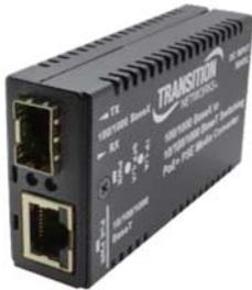
PoE機能付のミニ・メディアコンバータは、10/100/1000Base-T(RJ-45)ポートと挿入されるSFPトランシーバにより、例えば100/1000Base-SXまたはLXポート間でコスパ最高のメディア変換を提供します。光トランシーバ受入可能なため、展開はプラグアンドプレイで可能であり、サイズが小さいため、設置スペースが限られている場所に最適です。データリンク層であるレイヤー2で動作するこのコンバータは、銅・ケーブルを光ファイバに変換するだけでなく、従来の10/100デバイスを1000Base-SX/LXファイバに接続できるようにするレート変換も同時に提供します。TPケーブルから光ファイバへの変換を提供しながら
