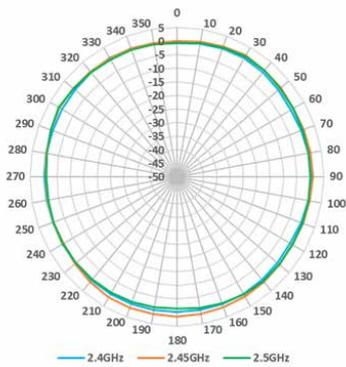
Radio1 2.4 GHz 水平面
