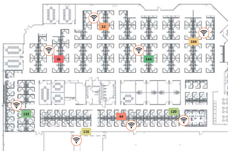
企業内オフィス環境で ChannelFlyが作成した チャンネル設計例(20MHz)
